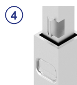
④ Auszugssicherung 150N gem. DVGW GW336
