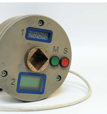
Zeigerwerk mit Lichtwellen- k und Digitalanzeige.
