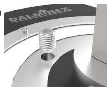
Gewindestift M8x10 mm Material: 1.4301
