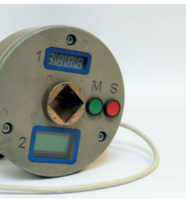
Zeigerwerk mit Lichtwellen- k und Digitalanzeige.
