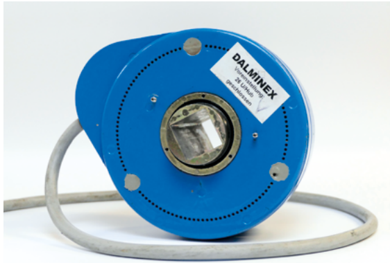
1. Elektrisches Räderzeigerwerk mit Magnetschalter-Technik.
