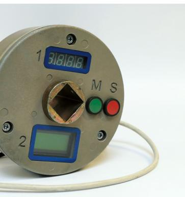
Elektrisches Räderzeigerwerk mit Reed-Kontakten zur Kalibrierung am
